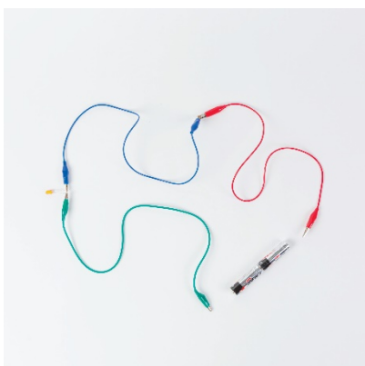
Circuit électrique ouvert
